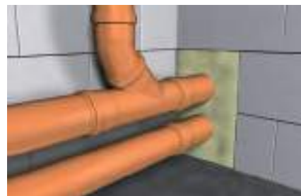
Wypełnianie prześwitów i bruzd dla rur
