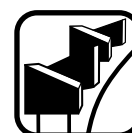
Uzębienie naprzemiennie (wstawki z węglików spiekanych)
